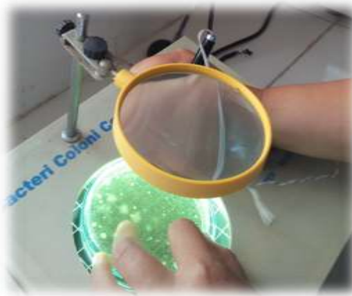
Gambar 5.3.5a. Perhitungan Total Plate Count (TPC) menggunakan coloni counter .
